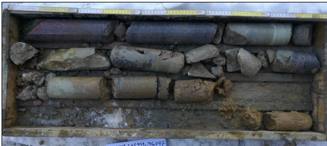
Obr. č. 1 - diagnostický vrt Š1 do dřívku zdi v km cca 245,973
