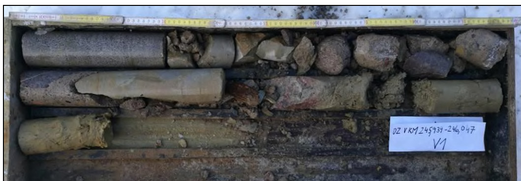
Obr. č. 2 - diagnostický vrt V1 do dřívku zdi v km cca 245,972
