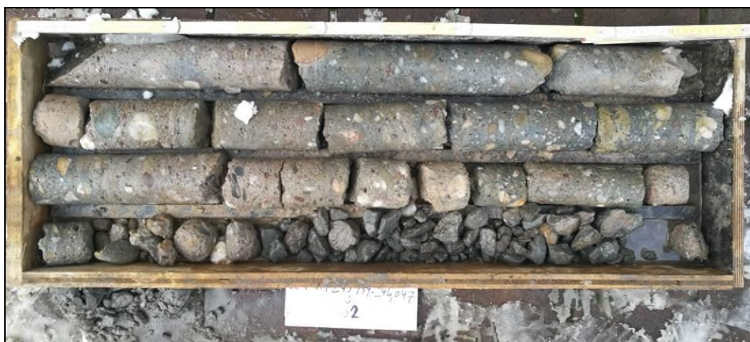
Obr. č. 3 - diagnostický vrt Š2 do dřívku zdi - v km 246,013
