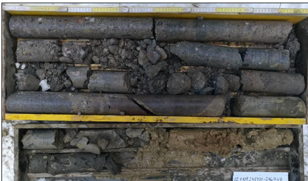
Obr. č. 4 - diagnostický vrt V2 do dřívku zdi - v km 246,012
